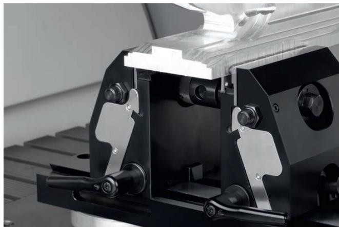
Pieza bruta tensa. Sujeción segura mediante pines de sujeción en unión continua.
