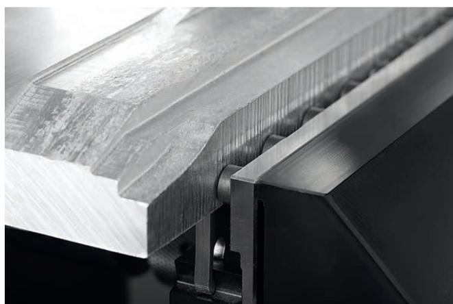
Pieza bruta después del proceso de tensado. Se puede ver la huella de los pines de sujeción en el borde de sujeción de la pieza de trabajo.
